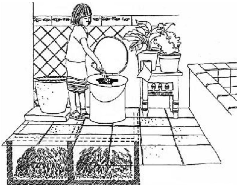
*Hình 3.5 Biến thể của nhà tiêu hai ngăn Việt Nam ở Mêhicô, được xây dựng trong phòng tắm trong một ngôi nhà tiêu chuẩn cao hiện đại ở thành phố Cuernavaca. Nhà tiêu có bệ tiêu xổm di chuyển được với chỗ thoát nước tiêu. Hầm cầu phía dưới nhà tắm có thể lấy phân được từ bên ngoài nhà.*
