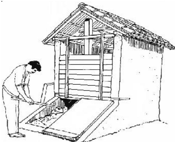
**Hình 3.10 Nhà tiêu 2 bể với tấm đón nắng mặt trời ở Ecuador.**
